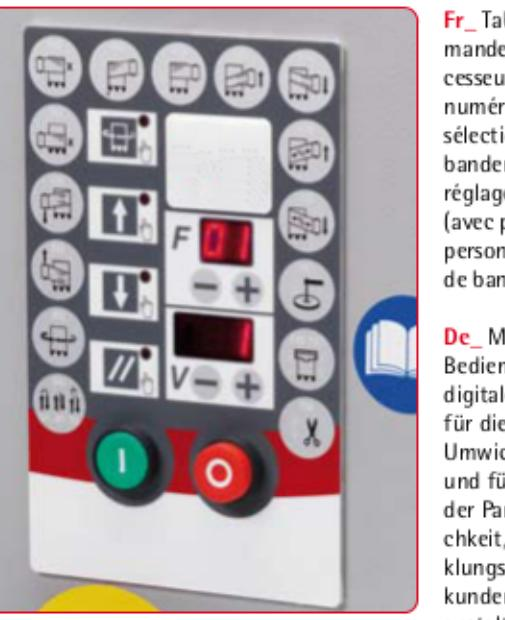
**Fr** Tableau de commande à microprocesseur avec panneau numérique pour la sélection du cycle de banderolage et pour le réglage des paramètres (avec possibilité de personnaliser le cycle de banderolage).
